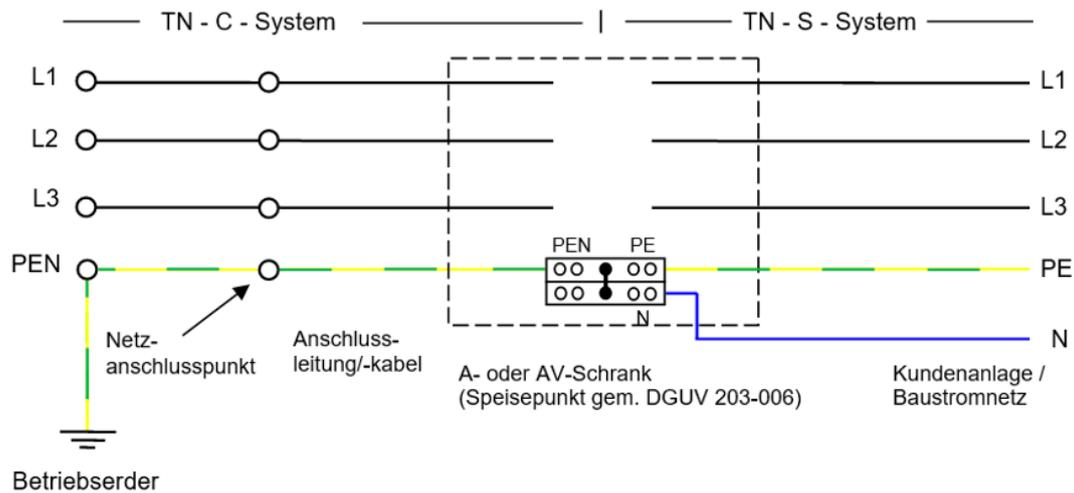
Abbildung 7 - Anschlussmöglichkeiten am Beispiel des TN-C-Systems
